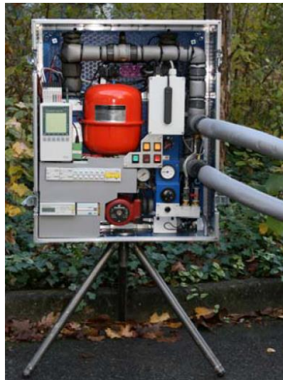
Le mini-module de TRT développé par l'EPFL
